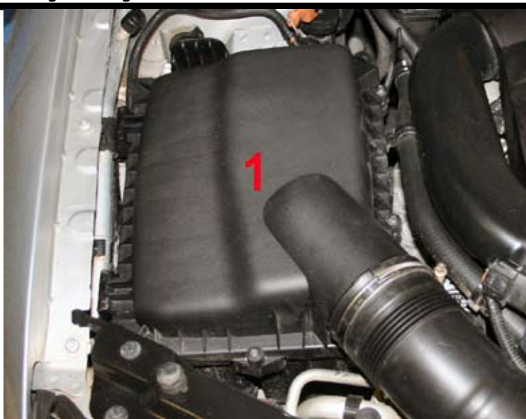
2. Demontera luftfiltermodulen (1). Börja med ovandelen. Lossa torx-skruvarna och slangklämman. Lyft ur underdelen. Original gummigenomföringar ska inte användas.
