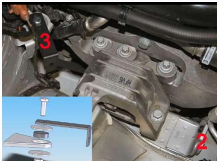
3. Tryck i gummigenomföringen (2) och montera staget (3) med M8 skruv/mutter utan att dra åt fullt. Montera brickorna enl. bild.
