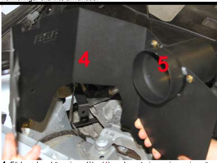
4. Förbered avskärningsplåten (4) med montering av insugningsröret (5). Använd M5.
