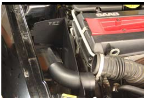
4. Montera avskärmningsplåten, använd befintliga original fästen.
