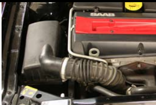
2. Lossa insugningsslangen från luftfiltermodulen.
