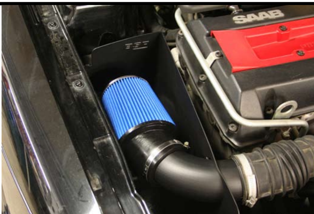
5. Montera insugningsslangen och skruva åt. Montera BSR luftfilter, drag åt slangklämman lätt.
