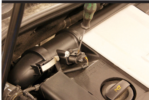
1. Demontera kontaktstycket från luftmassmätaren (LMM). Använd spårmejsel enligt bild.
