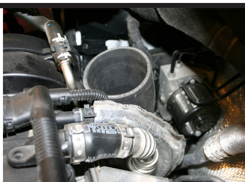
5. Montera BSR insugsslang, låt den peka framåt. Dra åt med slangklämma 50-70mm.
