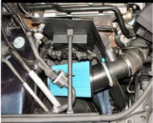
Montera luftfiltret och anslut insugningsslangen. Montera urluftsrioret med buntband(2st) och slangklämma som medföljer.
