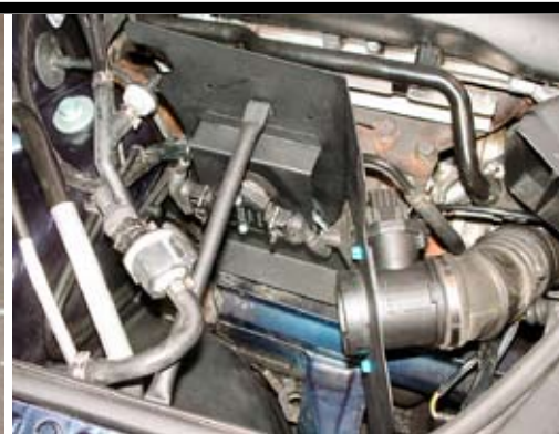
6. Montera avskärmningsplåten i originalfästena genom att använda medföljande stag. För kablaget genom "vinkelplåten till slutsteget" och anslut kabelstyckena till laddtryckreglerventil, luftmängdmätare, slutsteget och urluftsventilen.
