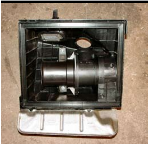
4. Öppna luftfilterlådan och demontera luftmängdmätaren. Hållaren och tätningsringen användes ej.
