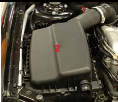
2. Demontering: Lossa kontaktstycket till luftmätaren (1). Demontera luftfiltermodulen (2) inklusive luftmätaren i ett stycke.
