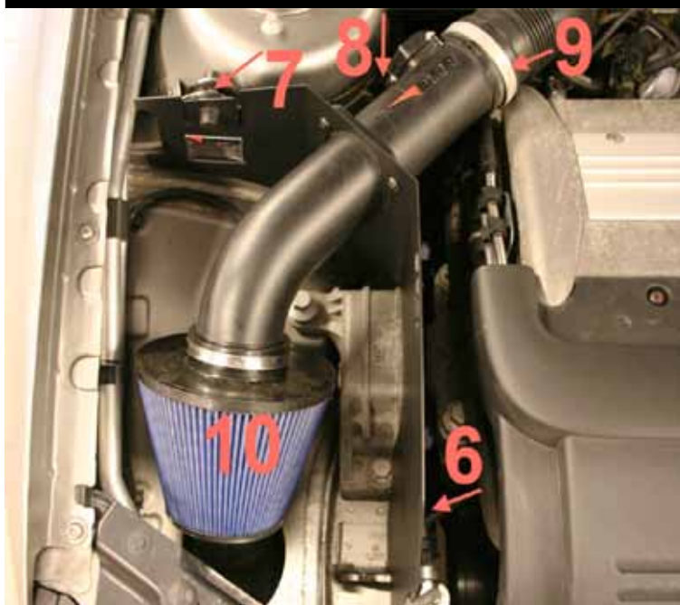
5. Montera avskärmingsplåten i bilen. OBS! Original gummigenomföringar ska inte användas. Fäst främre fästet (6) och det bakre (7). Till det bakre fästet används gummibrickor/planbrickor och den längre M8 skruven. Gummibrickorna monteras mellan avskärmingsplåten och karossens fästen. Passa in avskärmingsplåten och dra åt fästpunkterna. Montera plasthylsor (2st) över bakre fästets skruvförband (7). Anslut kontaktstycket till luftmätaren (8). Dra åt slangklämman (9). Montera luftfiltret (10).
