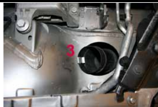
3. Fäst original luftintag i karossen enligt bild. Använd medföljande klips.
