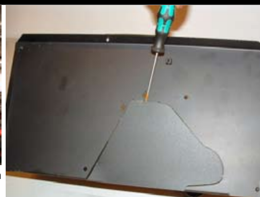
6. Demontera den utskurna delen på framsidan av den nya avskärningsplåten. Bryt loss den övre fästpunkten. Tryck sedan plåten fram och tillbaka tills den lossnar.
