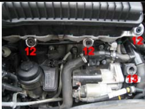
8. Montera plastdistanserna i gummifästena (12).
