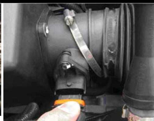
3. Bryt spänningen till batteriet. Lossa kontaktstycket från luftmassmätaren. Demontera insugningsslangen från luftmassmätaren.
