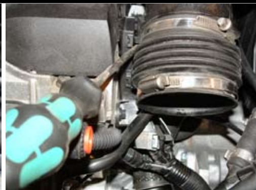
9. Bilar med automatladda: Öppna kabelstammens plasthölje.
